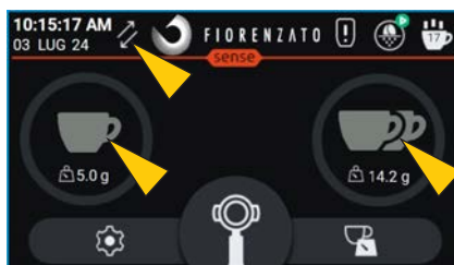
HOME con sistema "SENSE" attivo in comunicazione con il gruppo di pesatura
